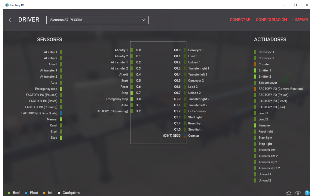
Ilustración 2. Entradas y salidas configuradas en Factory IO
