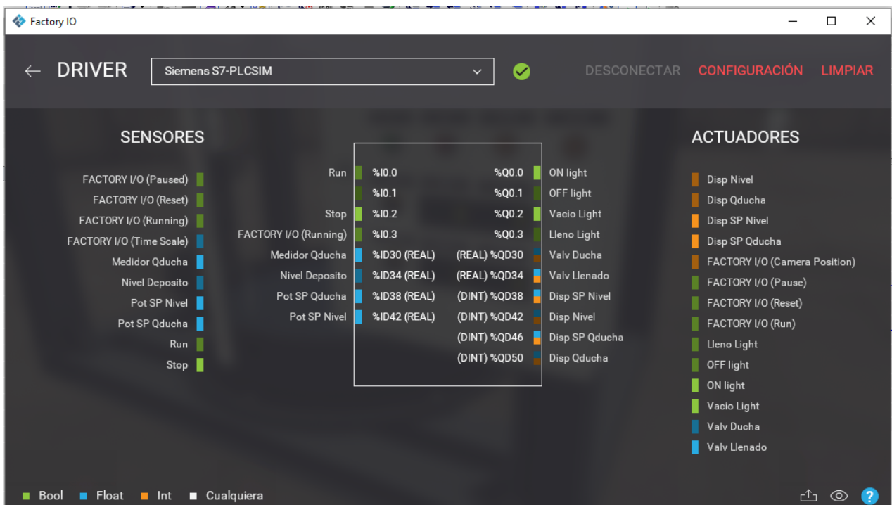
Ilustración 2. Entradas y salidas configuradas en Factory IO
