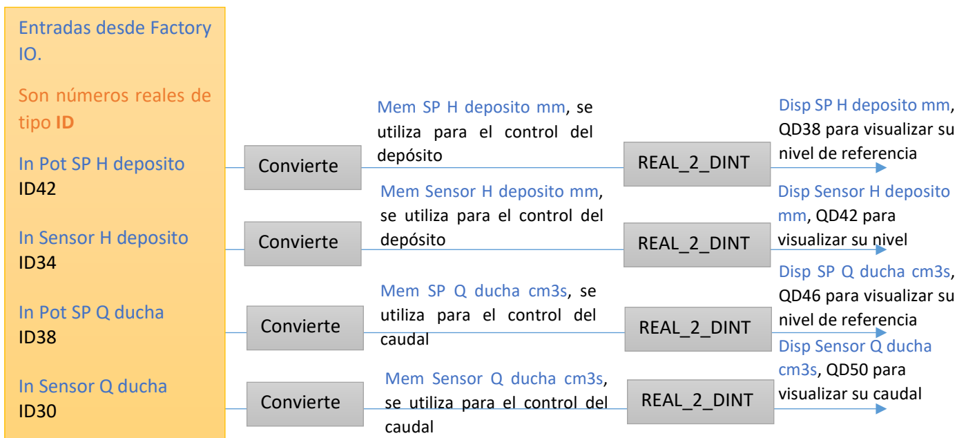
Ilustración 4. Resumen de las variables utilizadas por potenciómetros y displays
